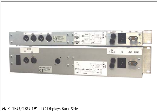
Fig.3 1RU/2RU 19" LTC Displays Back Side
